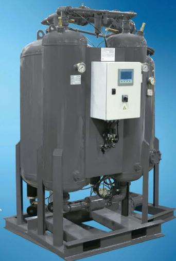
Los secadores de adsorción de las series SDA y SDADWG garantizan un suministro estable de aire comprimido clase 2 y clase 1 según norma ISO 8573.1:2010, mediante la utilización de adsorbentes de alta calidad. El agente secante extrae la humedad del aire comprimido hasta un punto de rocío a presión de  $-40^{\circ}\text{C}$ ; opcionalmente hasta  $-70^{\circ}\text{C}$ . Esto asegura unos procesos de producción sin dificultades y rentables.
