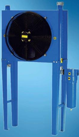
El refrigerador posterior es un intercambiador de calor que se instala a la salida de los compresores para bajar la temperatura del aire comprimido. El intercambio puede ser Aire/Aire o Aire/Agua. Suele llevar instalado un separador de condensados a la salida.
